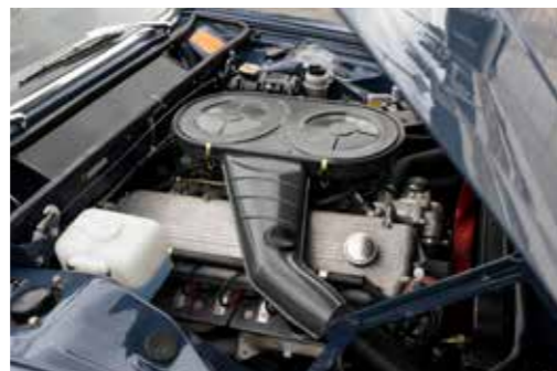
ベースのBMW2800が搭載するのは170psを発生する2788ccの直列6気筒エンジン。BMWが直6を初搭載したモデルだ。
